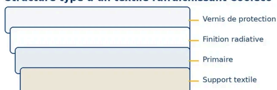
Structure type d'un textile rafraîchissant Cooleco
